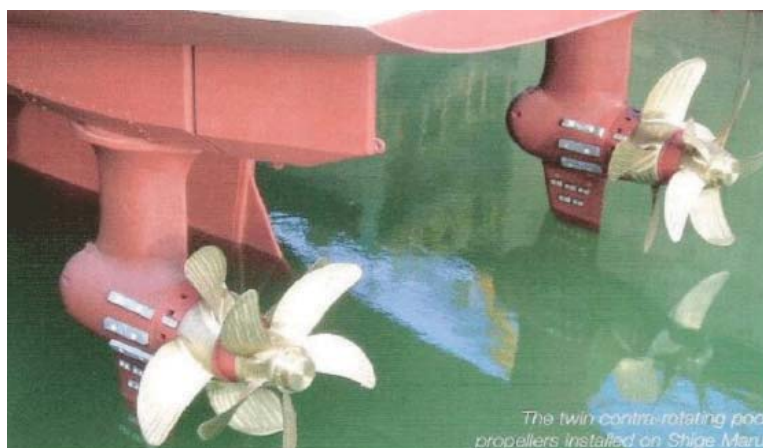
Rys. 6. Napęd dwoma pędnikami gondolowymi (śruby przeciwbieżne) statku „Shige Maru” [2] Fig. 6. The twin contra-rotating pod propellers installed on “Shige Maru” [2]
