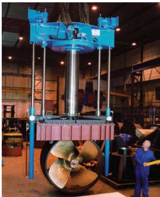
Rys. 4. Pędnik chowany jako awaryjny napęd główny i dziobowy ster strumieniowy Fig. 4. Retractable thruster as an emergency propulsion and bow thruster
