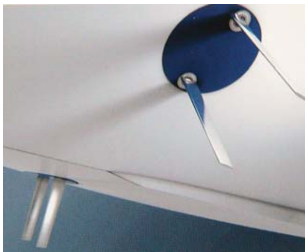
Rys. 7. Zastosowanie pędników VSP jako urządzenia antyprzechyłowego [8] Fig. 7. Voith-Schneider propellers as antiheeling device
