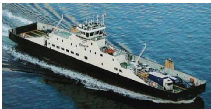
Rys. 2. Prom o podwójnej rufie Fig. 2. Double-ended ferry
