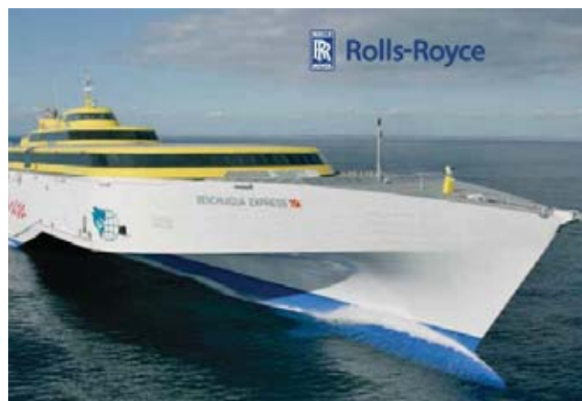
Rys. 9. Superszybki prom z układem napędowym firmy Rolls-Royce i pędnikiem strugowodnym Fig. 9. Fast ferry with a Rolls-Royce propulsion system with gas turbine and waterjet
